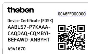
L'ETS produit, après la saisie de la FDSK, une clé outil spécifique à chaque appareil. Par le bus, l'ETS envoie la clé outil vers l'appareil devant être configuré. La transmission est codée et authentifiée au moyen de la clé FDSK d'origine précédemment saisie. Ni la clé outil, ni la clé FDSK ne sont envoyées en texte clair via le bus.
