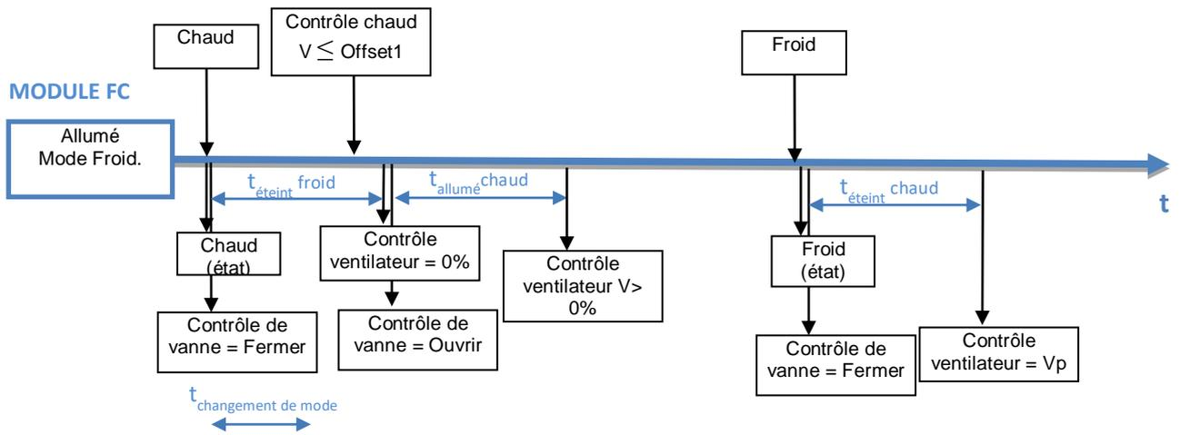
**Figure 18** Changement de mode avec ventilo-convecteur allumé: 2 tubes ("Les deux").
