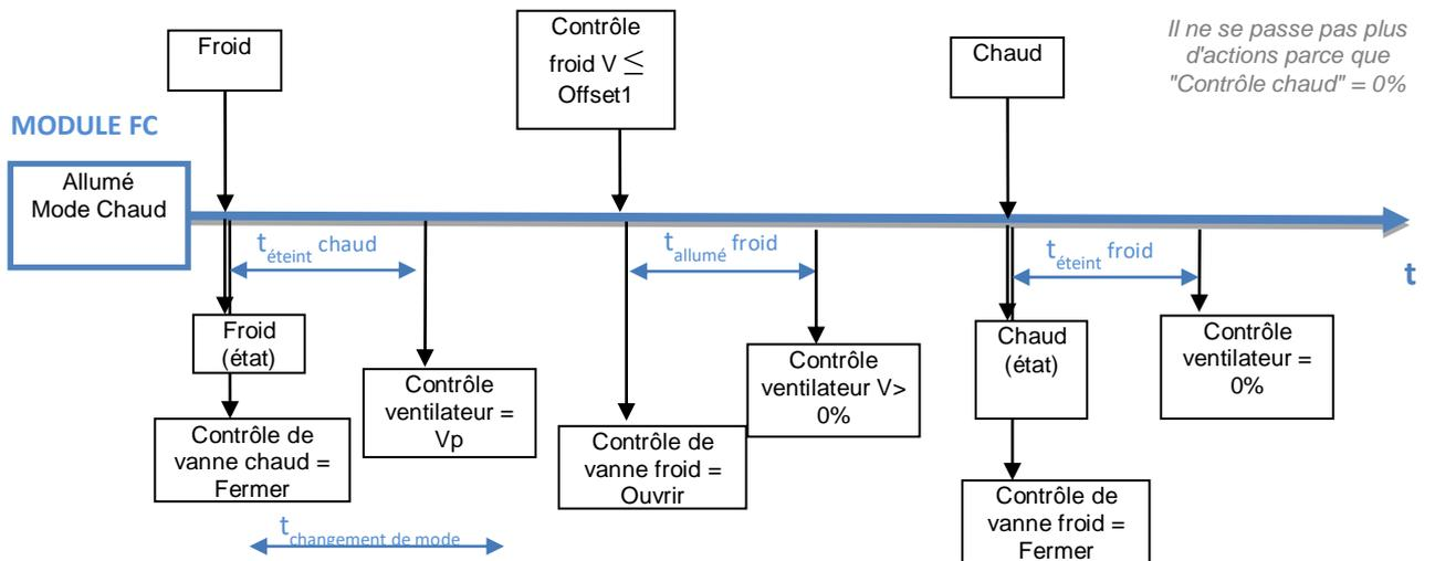
**Figure 19** Changement de mode avec ventilo-convecteur allumé: 4 tubes
