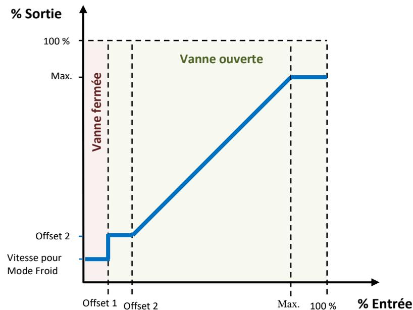
Figure 12 Pourcentage de sortie dépendant de la consigne d'entrée, les deux offsets et la vitesse du ventilateur avec la vanne fermée.
