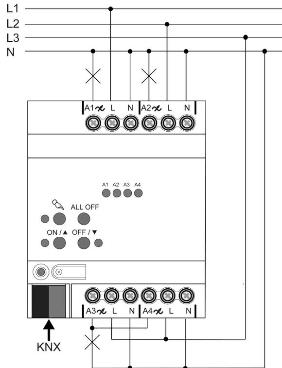
Figure 3: Raccordement d'appareil (exemple de raccordement)
