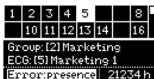
Figure 35. Erreurs du ballast
